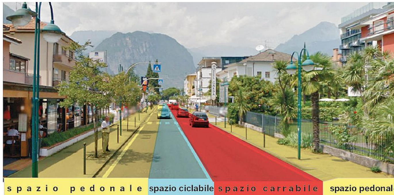
In viale Rovereto una sola corsia riservata al traffico di auto e mezzi pubblici. Il resto dello spazio è destinato a biciclette e pedoni
