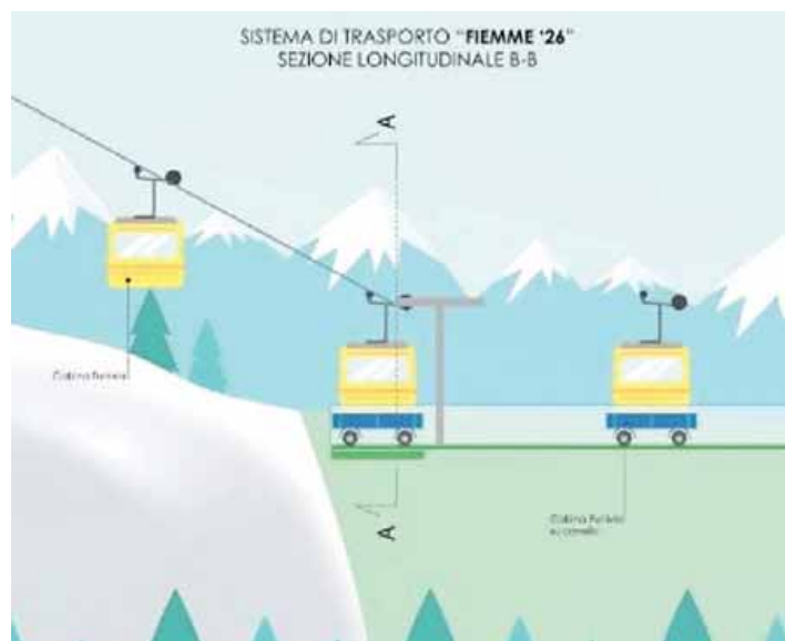
• Il rendering di una delle stazioni di interscambio. Sotto la simulazione di come le cabine passerebbero dalla fase su gomma a quella "aerea"
