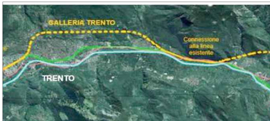
Il tracciato della circonvallazione ferroviaria nell'attraversamento di Trento. Sopra la zona dell'Acquaviva
