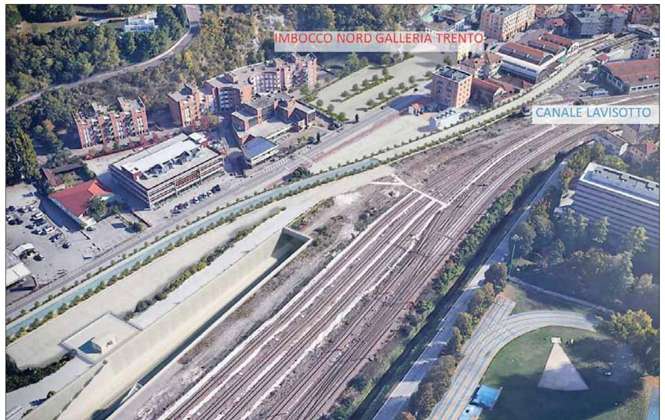
L'elaborazione grafica del progetto con l'imbocco a nord della galleria della circonvallazione ferroviaria in zona ex Scalo Filzi
