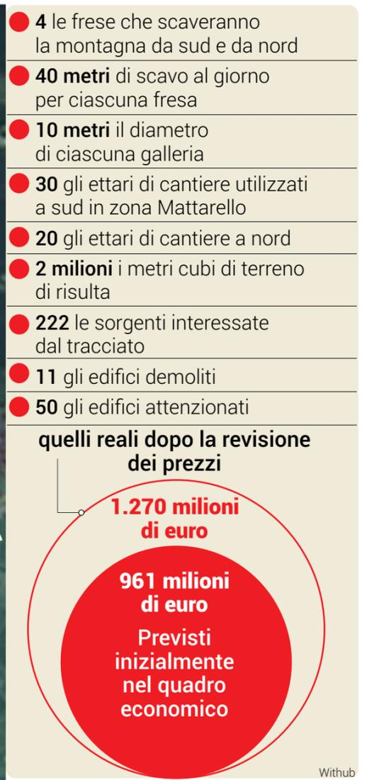
Il tracciato del bypass ferroviario di Trento che partirà a sud dalla località Acquaviva per rivedere la luce a nord all'inizio di via Brennero. Il tracciato sarà lungo 14 chilometri di cui 10,5 in galleria e gli altri in trincea passando per le aree inquinate ex Sloi ed ex Carbochimica
