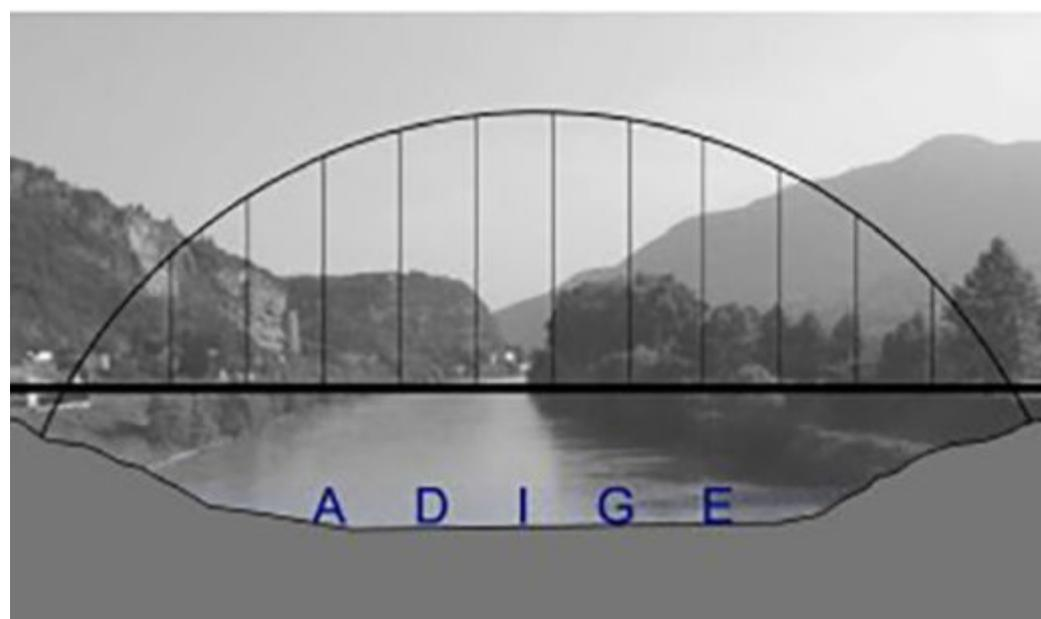
**Scenario 2** La struttura di sostegno della passerella è costituita da due archi ai lati, appoggiati sulla parte alta delle spalle degli argini
