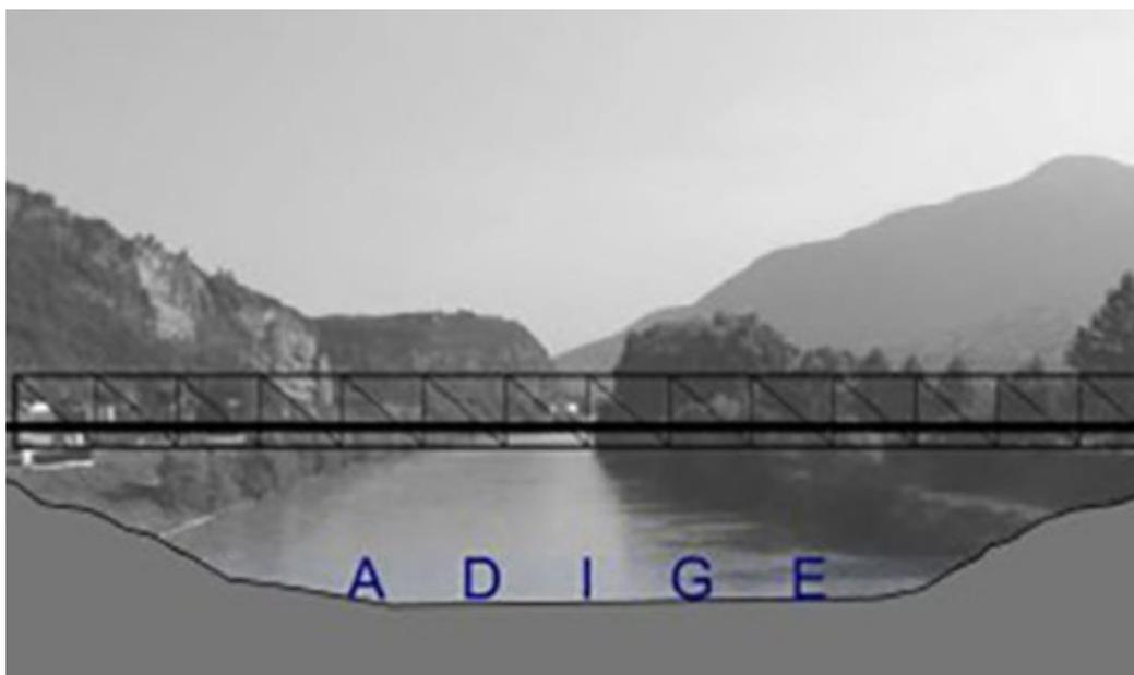
**Scenario 1** Passerella con doppia struttura reticolare laterale: le travi sono immaginate ai due lati del «ponte» ciclopedonale
