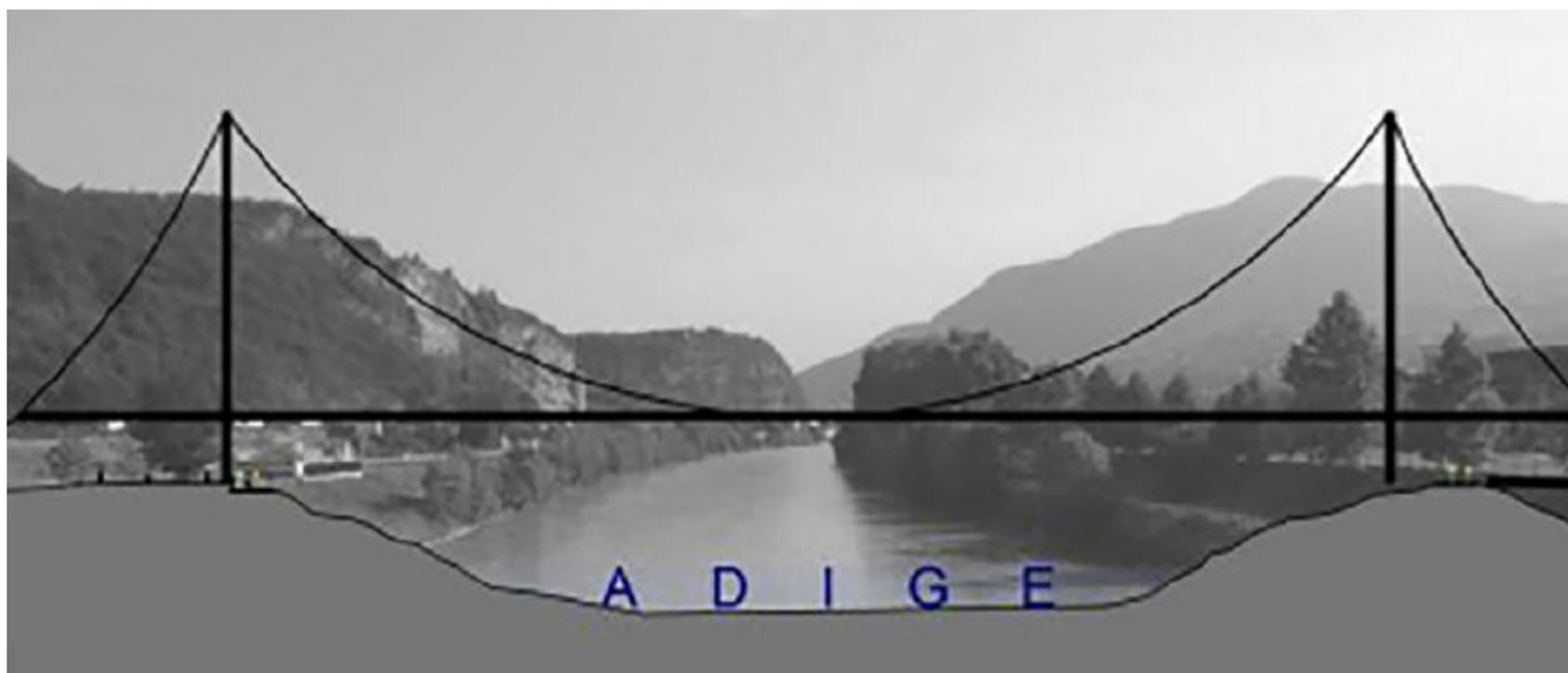
**Scenario 3** Prevede la realizzazione di due piloni sulle spalle dell'argine con la funzione di sostenere l'impalcato per mezzo di cavi d'acciaio con alcune varianti sull'ancoraggio a seconda di diverse valutazioni
