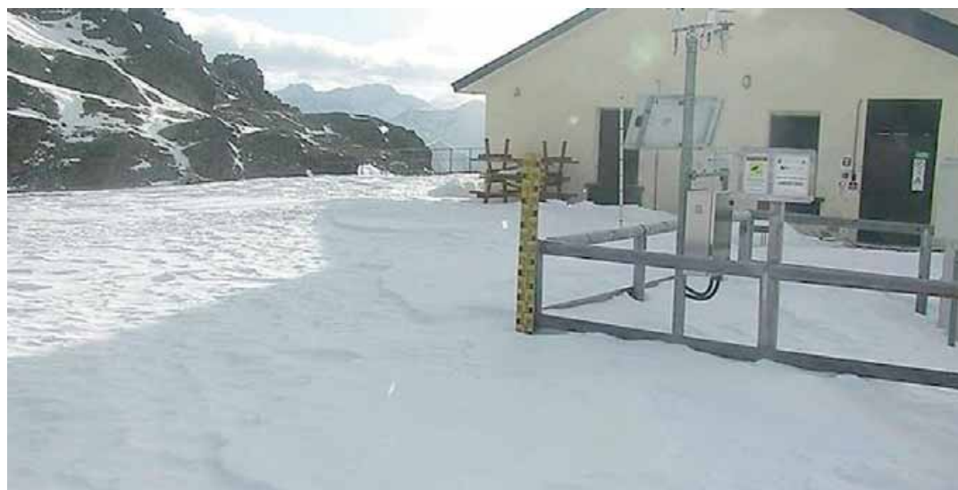
Il «palo neve» della Protezione Civile del Trentino alla diga del Careser, 2605 metri: ci sono solo 50 centimetri
