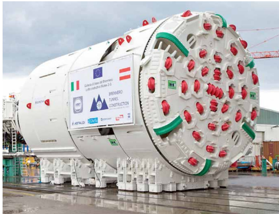
Una «talpa», la fresa delle gallerie: a Trento in azione quattro, due per direzione, su due canne
