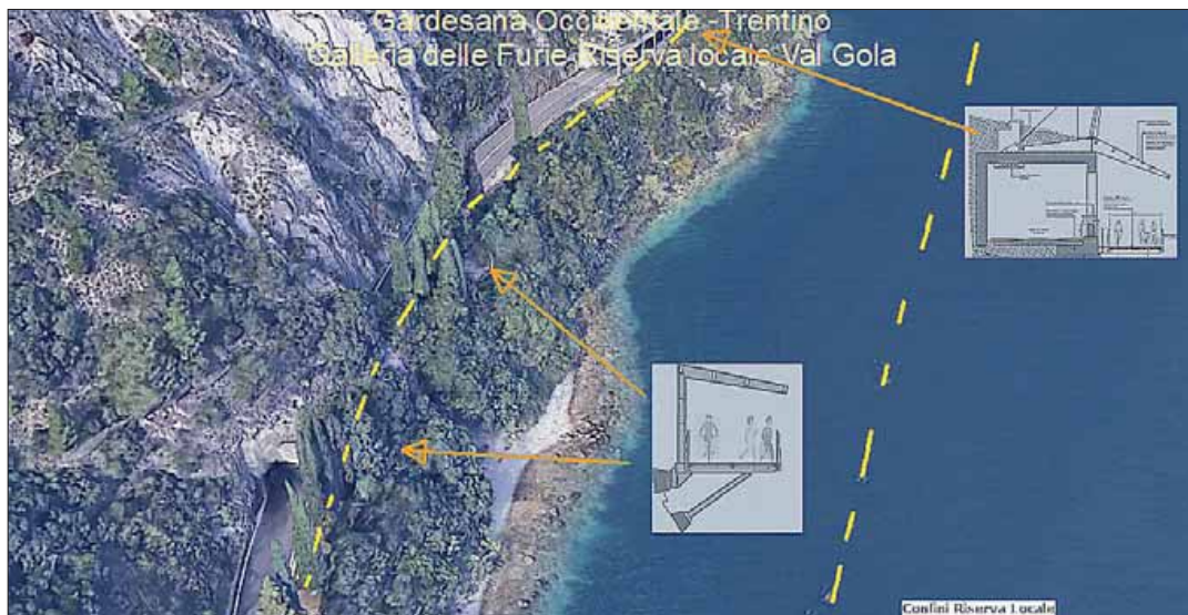
La Riserva naturale Val di Gola verrebbe stravolta dalle impattanti mensole a sbalzo (esposizione di 5 m dalla roccia)
